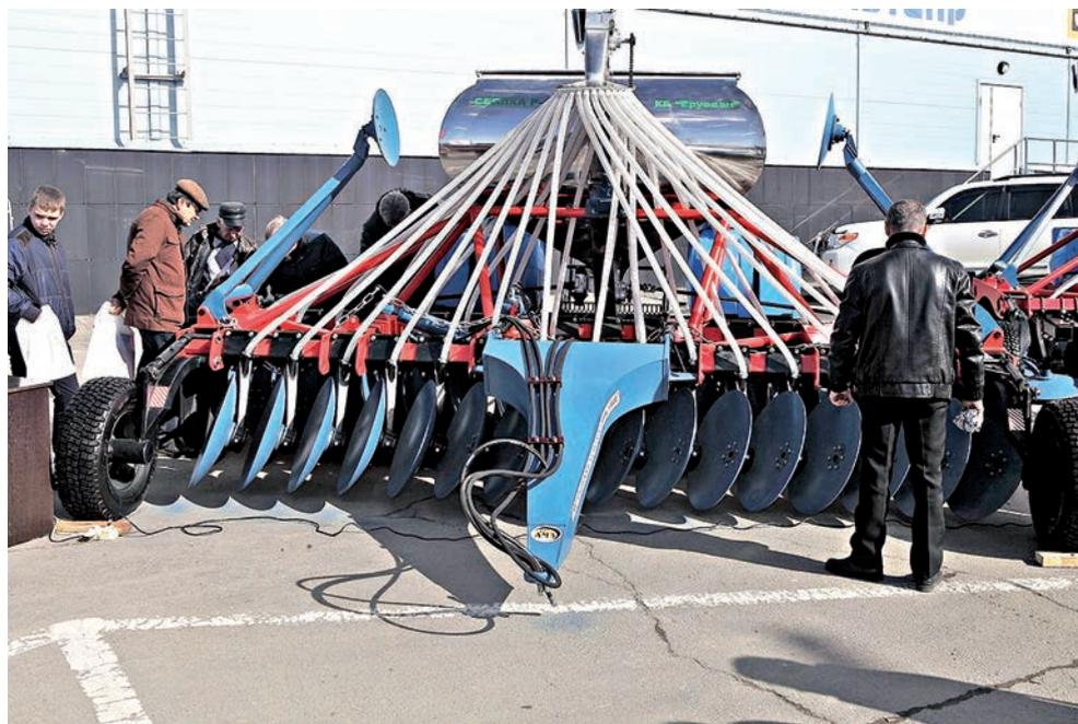
Полуприцепная почвообрабатывающая сеялка-культиватор «R»
