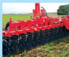
КРОНА - приставки прямого сева к серийным зерновым сеелкам типа СЗ (3,6, 5,4)
