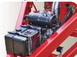
Дизельный двигатель обеспечивает постоянное давление в пневмосистеме
