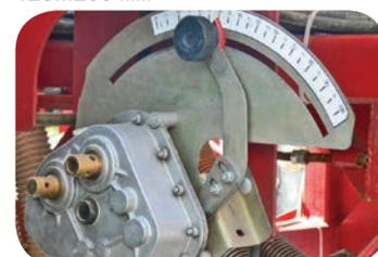
Вариатор обеспечивает бесступенчатую регулировку норм высева семян и удобрений
