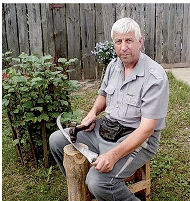
При отбивке косы удары молотком следует наносить строго параллельно лезвию полотна
