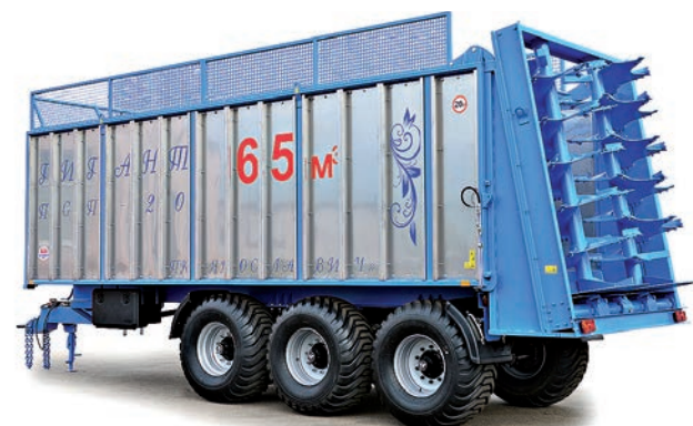
Полуприцеп ПСП-20 «Гигант» с разбрасывателем удобрений
