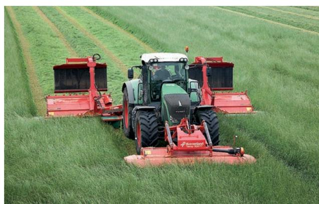
обеспечивают постоянное давление на почву при любых неровностях. Скашивающая секция может перемещаться на 50 см вверх и на 15 см вниз, и мы можем очень тонко настроить работу наших косилок».
