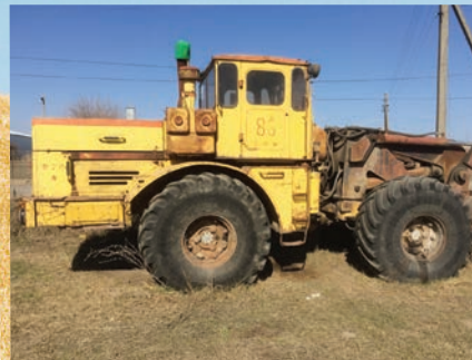
Погрузчик на базе трактора К-701 с двигателем ЯМЗ-240
