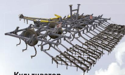
Культиватор комбинированный прицепной КПК-8С для сплошной обработки почвы
