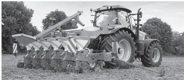
Пропашная пневматическая сеялка Kverneland Optima
